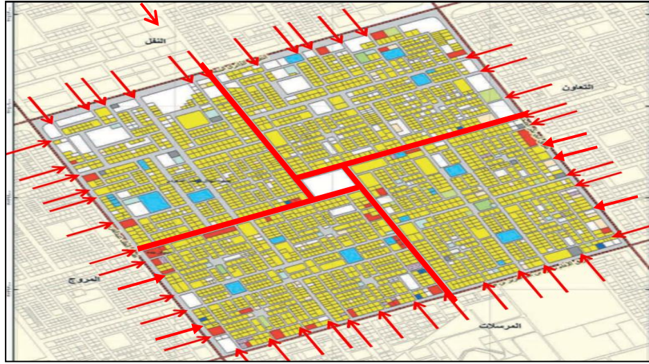
شكل رقم (٤) مخطط حي المصيف يوضح غياب التدرج الهرمي للشوارع، واستقامة الشوارع وامتدادها ونفاذيتها، والعرض الواسع للشوارع، والمداخل المتعددة للحي، وكثرة التقاطعات. المصدر: الهيئة العليا لتطوير مدينة الرياض
